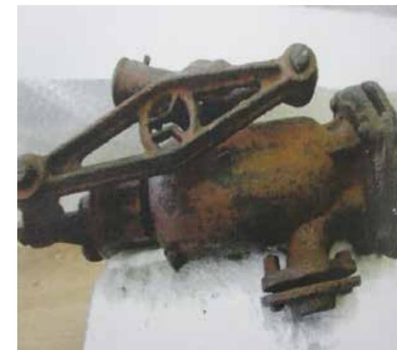
2012年にポンプを一旦切断後、劣化を防ぐため無酸素状態で東京都土木技術支援・人材育成センターに保管されていた、「古井戸」の鉄管ポンプ本体と吸い上げ管
